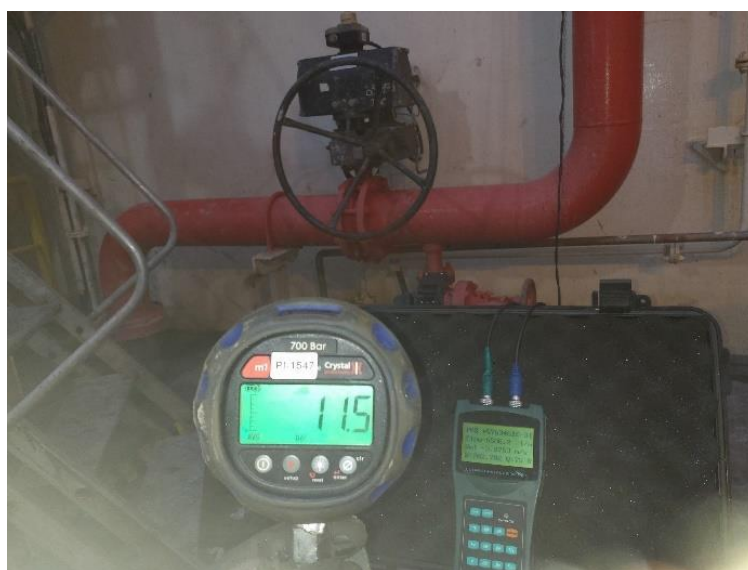
Figura 6: Medição de vazão e pressão na linha da ADV
